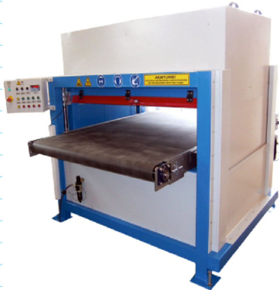
zwei Schleifkornbürsten gegenlaufend
